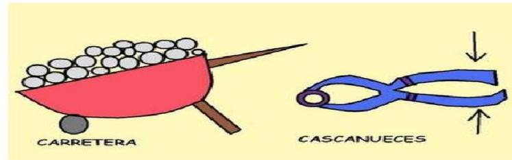
UNA MÁQUINA SIMPLE ES UN ARTEFACTO MECÁNICO QUE TRANSFORMA UN MOVIMIENTO EN OTRO DIFERENTE, VALIÉNDOSE DE LA FUERZA RECIBIDA PARA ENTREGAR OTRA DE MAGNITUD, DIRECCIÓN O LONGITUD DE DESPLAZAMIENTO DISTINTOS A LA DE LA ACCIÓN APLICADA.
