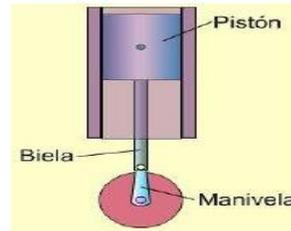
**Manivela:** Es una palanca con un punto al eje de rotación y la otra en la cabeza de la biela. Cuando el biela se mueve alternativamente, adelante y atrás, se consigue hacer girar la manivela gracias al movimiento general de la biela. Y al revés, cuando gira la manivela, se consigue mover alternativamente adelante y atrás la biela y el émbolo.
