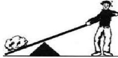
La **palanca** es una barra rígida con un punto de apoyo, a la que se aplica una fuerza y que, girando sobre el punto de apoyo, vence una resistencia. Se cumple la conservación de la energía y, por tanto, la fuerza aplicada por su espacio recorrido ha de ser igual a la fuerza de resistencia por su espacio recorrido.
