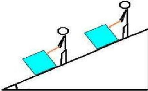
En el **plano inclinado** se aplica una fuerza para vencer la resistencia vertical del **peso** del objeto a levantar. Dada la conservación de la energía, cuando el ángulo del plano inclinado es más pequeño se puede levantar más peso con una misma fuerza aplicada pero, a cambio, la distancia a recorrer será mayor.
